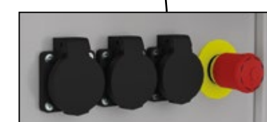
3 x Schuko + Not-Aus Schalter
